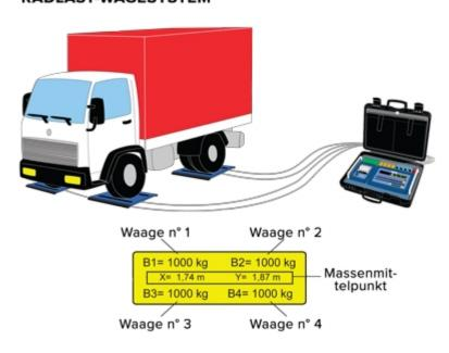
Geeignet zum Aufbau von Fahrzeug-Wägensystemen, statischen Achslast-Wägesystemen, zum Wiegen von Objekten mit mehreren Auflagepunkten. Besonders geeignet zur Wägung mit Schwerpunkt-Berechnung (Koordinaten) von Fahrzeugen, Lastwagen, Flugzeugen, Containern etc. Zeitgleiche Visualisierung des Gewichts jeder angeschlossenen Plattform und des Summen-Gewichts. CE-M eichfähig (OIML R-76 / EN 45501).
